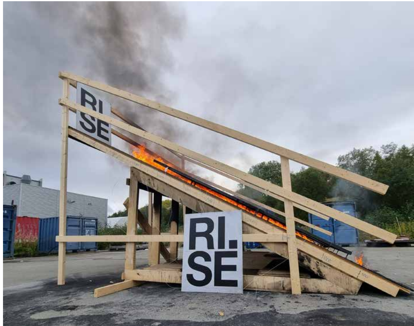
← Bildet er fra et fullskalaforsøk hos RISE Fire Research og viser brannspredning på et tak med solcellepaneler.
