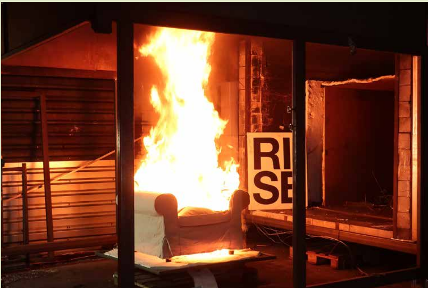
← Bilde fra branntest av en stoppet lenestol på det norske markedet, uten noen form for brannsikringstiltak.
