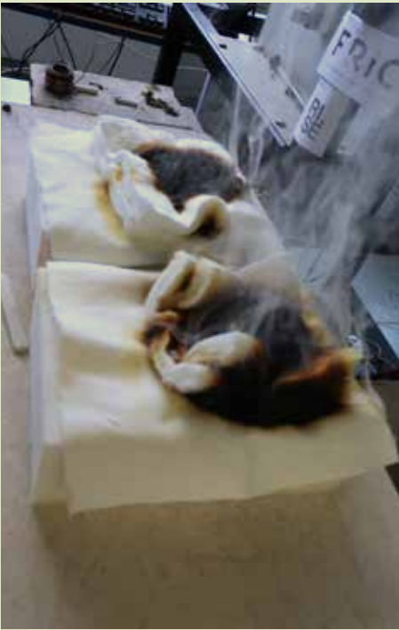
↓ Test av antennelighet av materialer til stoppete møbler.
