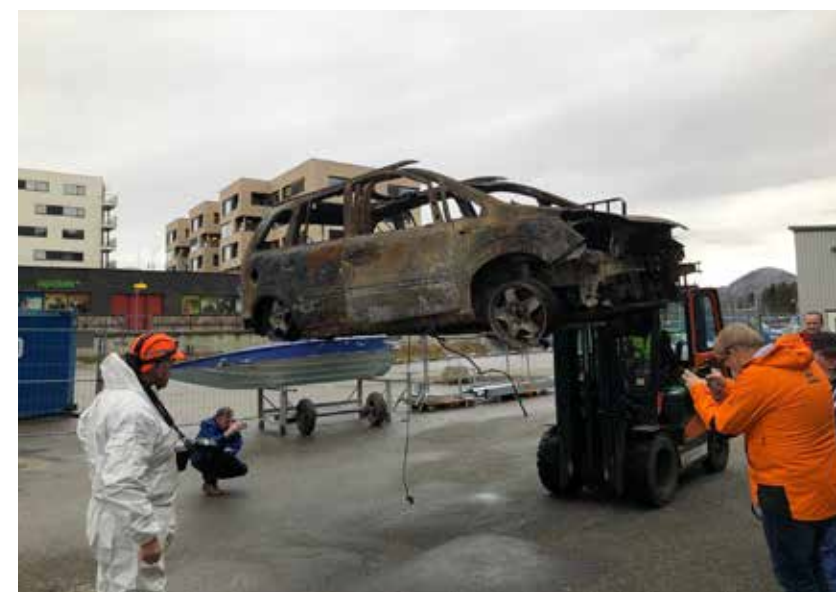
← Brannen i parkeringshuset på Sola i januar 2020 startet i denne bilen, en Opel Zafira. FaVer fikk tilgang til vraket og utførte grundige undersøkelser i samarbeid med flere andre aktører.
