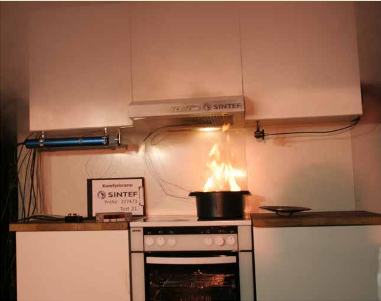
← Komfyrvakttest, det ble til slutt fyr i smultgryta.
