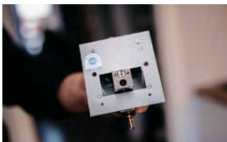
Rune Kibsgaard viser frem baksiden av en umontert høytrykksdyse med IR-kamera.
